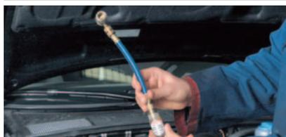
1. Avvitare il tubo d'immissione alla boccetta monodose contenente il liquido tracciante Art. 0892 764 010
