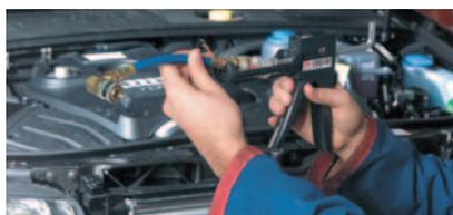
2. Inserire la boccetta monodose collegata al tubo d'immissione alla pistola d'estrusione e collegarsi all'impianto mediante attacco di bassa pressione
