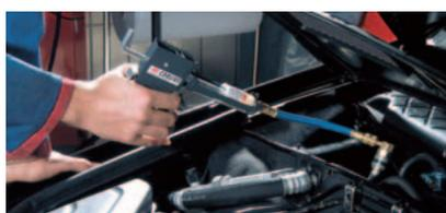
3. Iniettare l'intero contenuto nel circuito di condizionamento. Fare circolare il veicolo su strada con il climatizzatore in funzione per almeno un'ora e successivamente controllare l'effettiva perdita con la lampada UV Art. 0764 110
